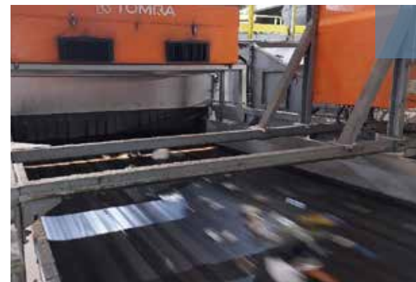
Ein Nahinfrarot-Detektor Sortiersystem zur Sortentrennung von Verpackungskunststoffabfällen bei der Meilo Gesellschaft zur Rückgewinnung sortierter Werkstoffe mbH & Co. KG. Foto: Professor Dr. Nico Bruns
