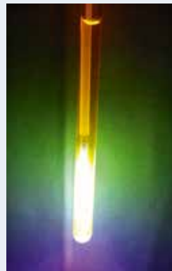
Belichtung einer Fluorescein-Probe in einem NMR- Röhrchen mittels Lichtwellenleiter
